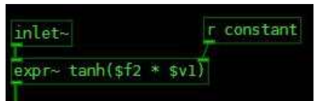
그림 8. purr-data로 설계한 쌍곡탄젠트 전달함수 시스템.
