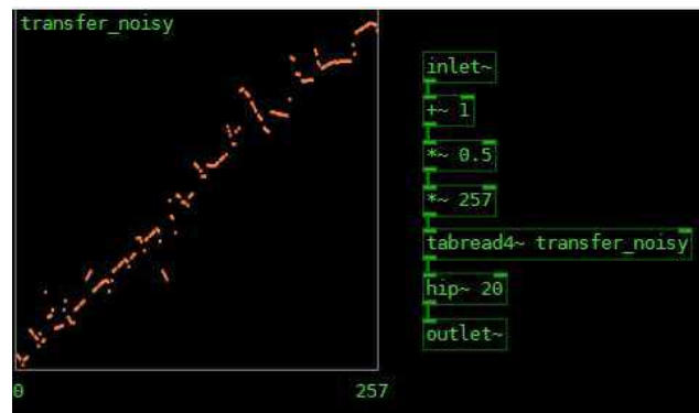
그림 38. purr-data로 설계한 노이즈가 낀 항등함수를 전달함수로 갖는 시스템
