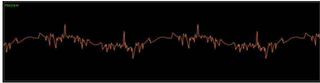
그림 40. 노이즈를 포함한 항등전달함수 시스템의 정현파 왜곡 결과에서 노이즈 성분만 추출한 파형
