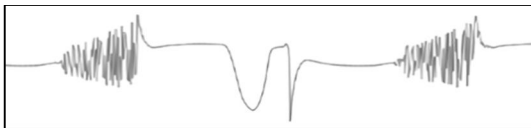
그림 47. BOSS DS-1 디스토션 이펙터를 통과한 후의 정현파
