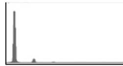
그림 9. 정현파 입력 후, y = \tanh x 를 전달함수로 설정한 실험결과.
